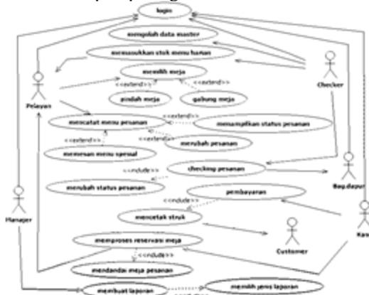
Gambar 2. Use Case Diagram Aplikasi Pelayanan pada Restoran
