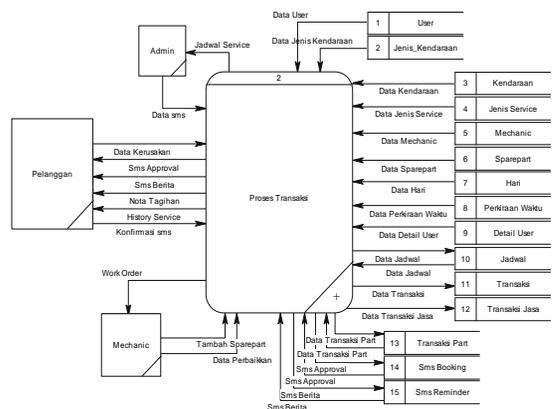
**Gambar 4** DFD level 0 Melakukan Proses Transaksi.
