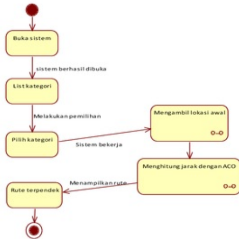
Gambar 7. Statechart diagram menghitung jarak
