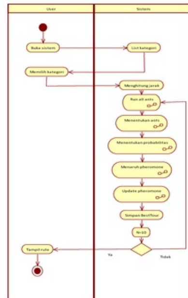
Gambar 4. Activity diagram menghitung jarak
