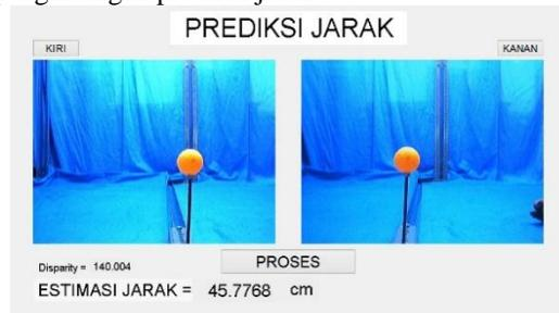
Gambar 16. Pengujian Pada Jarak 47 cm
