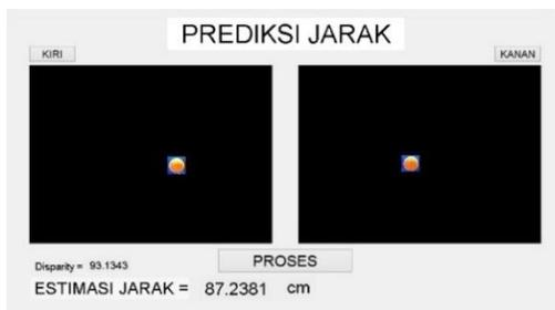
Gambar 19. Pengujian Pada Jarak 84,5 cm Setelah Gambar di-Edit
