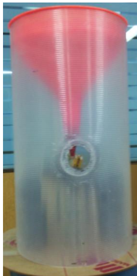
Gambar 4. Sensor Curah Hujan Tipping Bucket yang Digunakan
