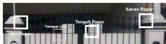
Gambar 19. Posisi peletakan ESP32-CAM
