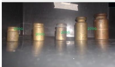
Gambar 13. Deteksi anak timbangan menggunakan background hitam
