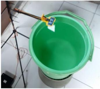
Gambar 7. Sensor Ultrasonik mengambil data pada benda cair
