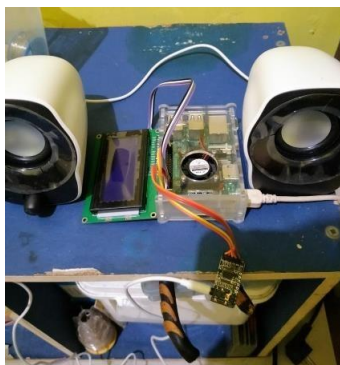
Gambar 6. Tampilan Koneksi Raspberry Pi dengan PCM5102 dan Speaker
