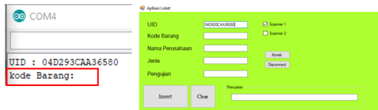
Gambar 9. Pemindaian tag RFID yang belum diberi kode barang
