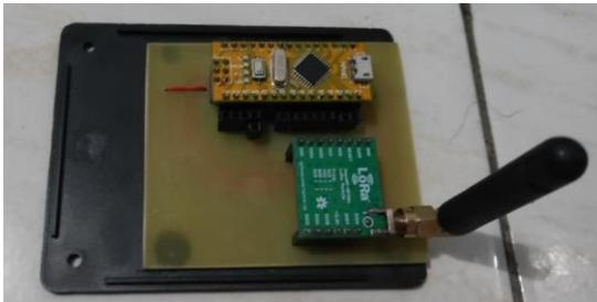
Gambar 4 Tampak dalam *Prototype* LoRa (Rx dan Tx)
