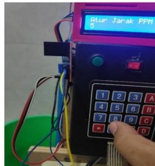
Gambar 10. Pengujian LCD dan keypad (2)
