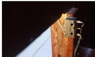
Gambar 4. Peletakan sensor *Limit Switch*
