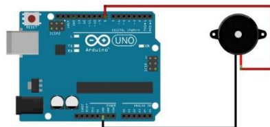
Gambar 16. Rangkain Buzzer dengan Arduino
