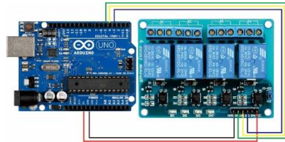
Gambar 14. Rangkain Relay dengan Arduino
