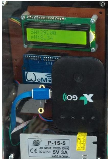
Gambar 10. Tampilan monitoring pada LCD
