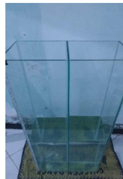
Gambar 13. Bentuk mekanik wadah pengukuran
