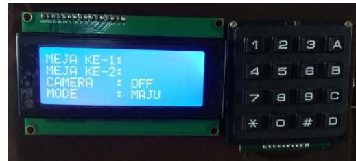
Gambar 4. Tampilan Display LCD dan Keypad Arduino
