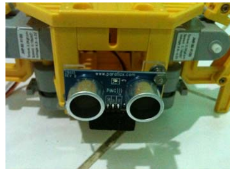
Gambar 5. Penempatan sensor ultrasound
