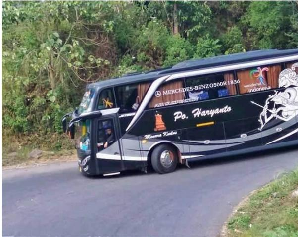
Gambar 4. 4 Bus yang Bersinggungan dengan Tanah 4
