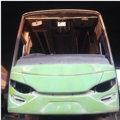
Gambar 1. 1 Bumper Bus dengan Material *Fiber*
