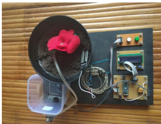
Gambar 1.2 Contoh desain pot tanaman dengan teknologi sensor soil moisture sensor (Sumber: https://repositori.usu.ac.id/ )
