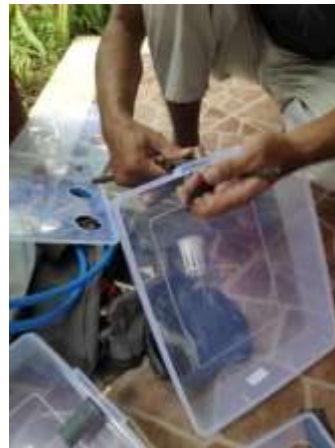
Gambar 4.25 Proses Pemasangan Konektor selang
